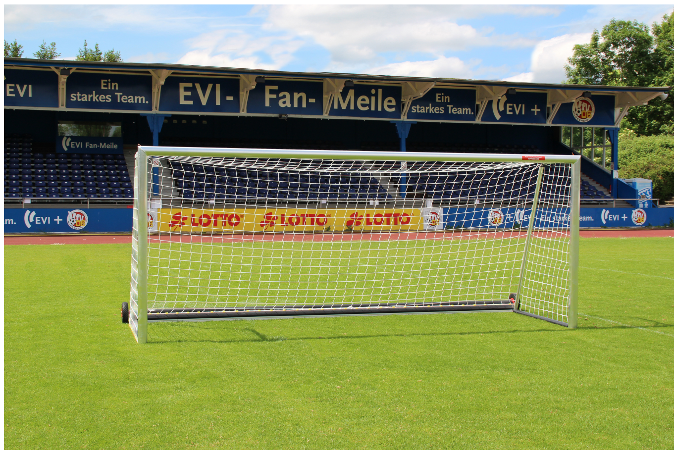
Safety-Jugendtor 5,00 x 2,00m aus Aluminium, vollverschweißt, Tortiefe 1,50m, zur Sandbefüllung mit Players Protect
